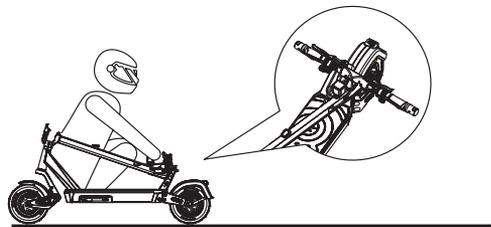
Sie können nun den eScooter an der Lenksäule anheben und transportieren. Halten Sie die Lenksäule mit einer Hand oder mit beiden Händen fest, um den eScooter zu tragen.
