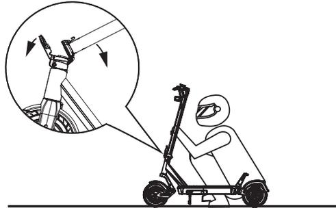
Klappen Sie danach die Lenksäule inkl. Lenker nach hinten in Richtung des Trittbretts und verbinden Sie den Klapphaken am Lenker mit dem Haken am hinteren Chassisabschluss.
