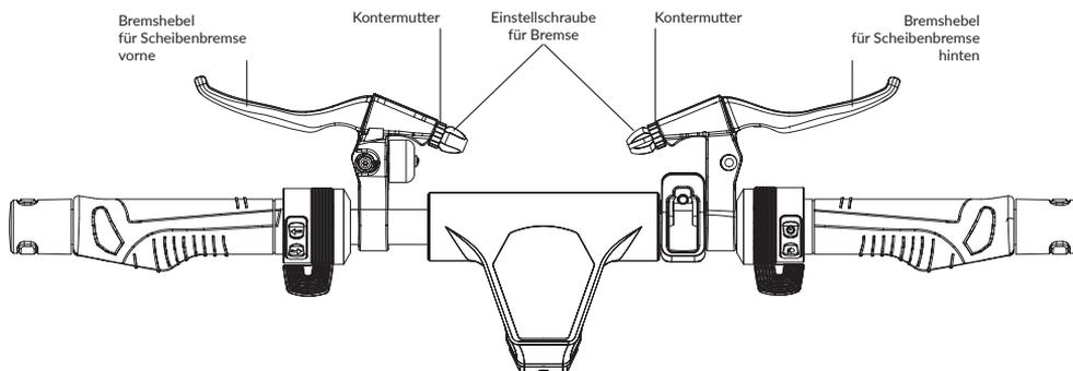
Lockern Sie die Kontermutter (1) durch Drehen gegen den Uhrzeigersinn.
