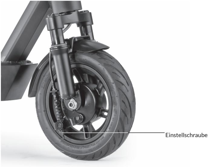
Zur Einstellung der Trommelbremse lösen sie die Kontermutter an der Einstellschraube.
